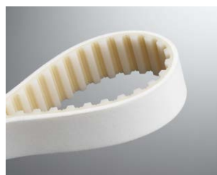
呼称：人工皮革 型番：ET-12U-2T 特長：耐摩耗・傷防止に優れる 用途：銅板、建材
