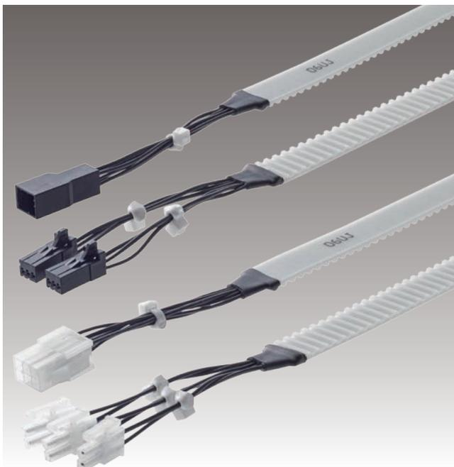
送電に使えるタイミングベルト。ウレタン製のベルト本体とスチール心線の特性を活かし駆動と送電機能の両方を持たせることに成功。また、スチール心線は銅線と比べ屈曲疲労性に優れるため、最小曲げ半径が小さく、コンパクト設計、省スペース化が図れます。
