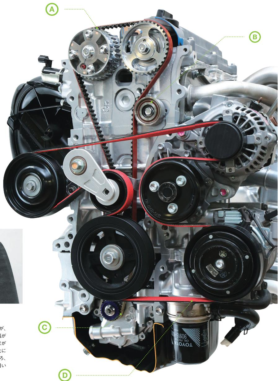
OHV全盛期で、SOHCが現れ始めた時期。そこからDOHCが登場して高回転高出力化、熱効率の追求による燃焼室のコンパクト化などが次々と課題になると、カムプリーの小径化が強く求められるようになった。ご存じ、カムシャフトはメインシャフトの半分の回転数で回るから、径は単純に倍となる。メインプリーとカムプリーを小さくできればエンジンはさらに小型化できる。タイミングベルトはピッチ（歯間寸法）9.525mmがスタンダードだったが、8.000mmのタイプが登場。これにより最少曲げ寸法を小さくでき、カムプリーの小径化を
